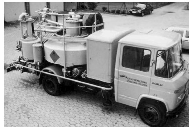
Prüfeinrichtung für größere Mineralölmessanlagen Eichkolben von 2000, 500 und 200 Liter Inhalt auf unterschiedlichen Fahrgestellen
