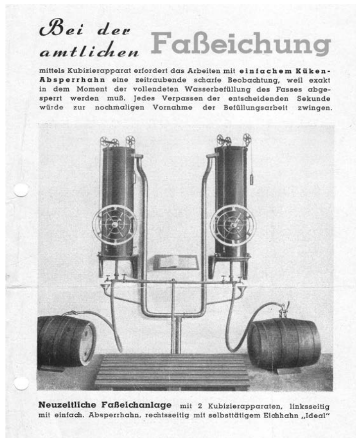
Mobiler Fasskubizierapparat Ende des 19. Jh. und eine stationäre Doppel-Anlage, wie sie noch bis in die neuere Zeit zur Anwendung kam und heute überwiegend durch eine Prüfeinrichtung mit Volumenzählern ersetzt worden ist.
