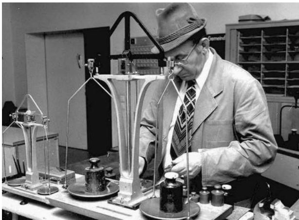
Ein Mitarbeiter des Eichamtes Lübeck während der periodischen Nacheichung von Gewichten (1976).
