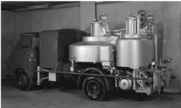
Prüfeinrichtung für größere Mineralölmessanlagen Eichkolben von 2000, 500 und 200 Liter Inhalt auf unterschiedlichen Fahrgestellen
