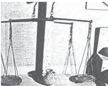
Gleicharmige bronzenene Ladenwaage (Fundort Pompeji)
