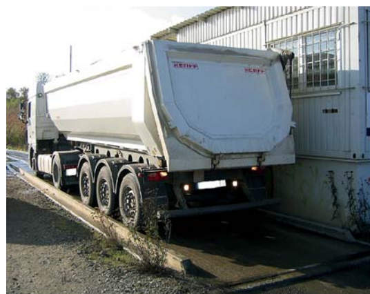
Wägung auf einer Brückenwaage
