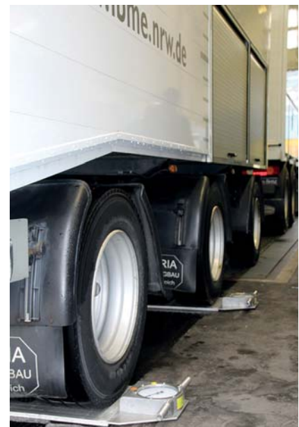
Statische Wägung auf einer Brückenwaage und Radlastwaagen
