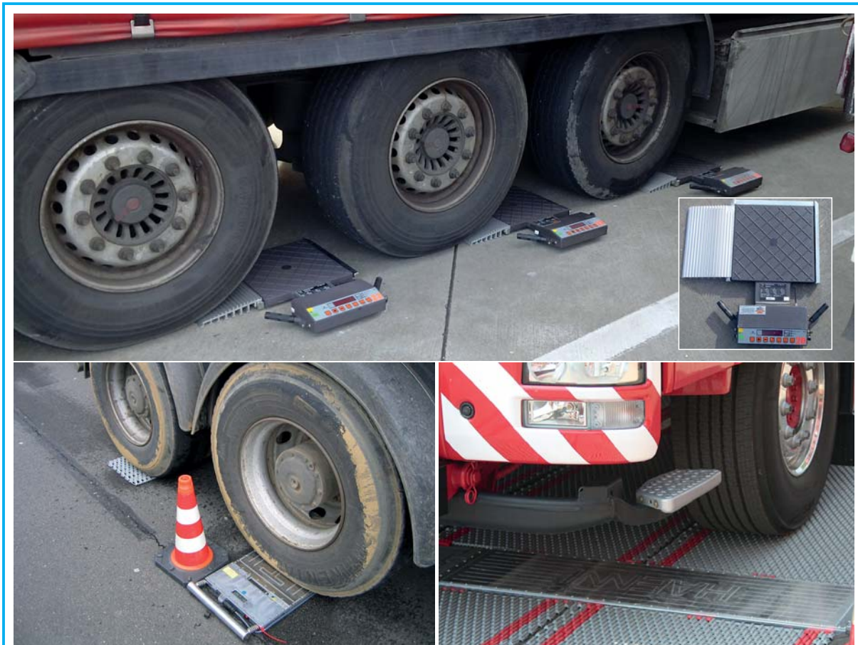
oben: Radlastwaagen-System mit Funkübertragung – gleichzeitige Messung bei Belastung aller Räder (EVOCAR) © Marco Mylius links: Wägung auf einer Radlastwaage, das linke Rad/Achse steht auf einer Ausgleichsmatte © HPA-F3 rechts: Auffahrt auf die Radlastwaage © Wolfgang Jaspers
