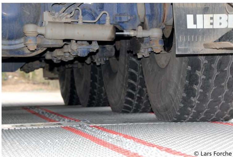
Ein Lkw bei der sehr langsamen Überfahrt, über die in den Ausgleichsmatten eingebetteten Radlastwaagen, zur Messung der Achslasten.
