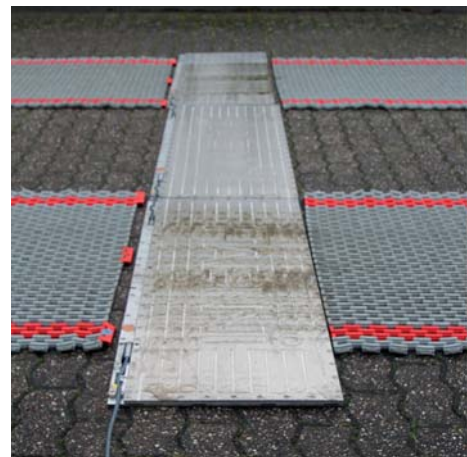
Die Auffahrt auf die Radlastwaagen zur Messung der Achslast muss in diesem Fall von rechts erfolgen, da der Kabeldurchlass für die Messkabel an der linken Ausgleichsmatte vorgesehen ist.
