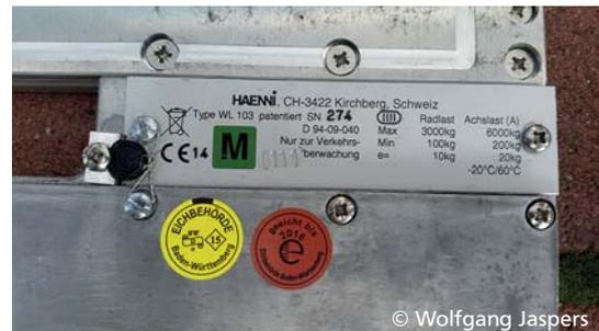
Die CE-Kennzeichnung ist bis zum 19. April 2016 zulässig gewesen! Das aufgebrachte Eichkennzeichen entspricht der MessEV.
