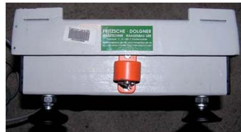
Nivellierfüße der Waage mit Libelle (rot) zur waagerechten Ausrichtung.
