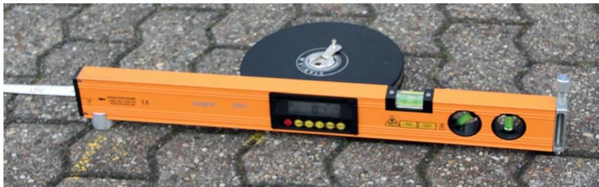
Anzeige der Laser-Neigungswasserwaage (Gefälle/Steigung in Prozent oder in Grad)
