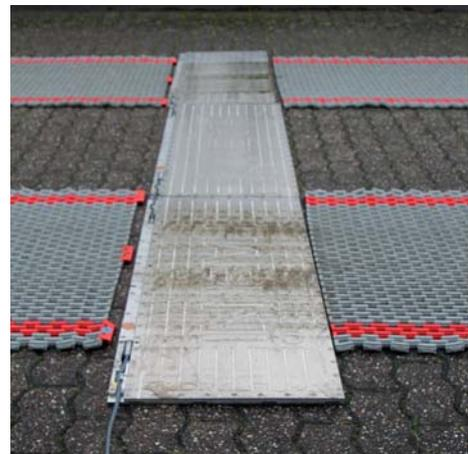
Die Auffahrt auf die Radlastwaagen zur Messung der Achslast muss in diesem Fall von rechts erfolgen, da der Kabeldurchlass für die Messkabel an der linken Ausgleichsmatte vorgesehen ist.
