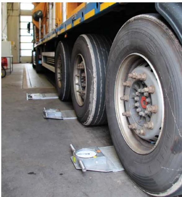
Foto oben: Die Radlastwaagen mit elektronischer und analoger Anzeige wurden vor die letzten drei Achsen des Sattelzuges positioniert.
