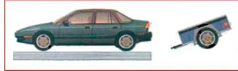
Die Stützlast ist ein errechneter Wert aus zwei Wägeergebnissen. Es ist die Differenz zwischen der ersten und zweiten Wägung zu bilden. Von dieser Differenz sind die Verkehrsfehlergrenzen (VFG) der jeweiligen Wägung zu Gunsten des Verkehrsteilnehmers abzuziehen. Siehe hierzu den Artikel auf **Seite 52**.
