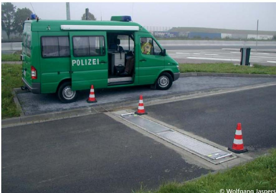
Die Radlastwaage ist in der Fahrbahn eingelassen, um auf Ausgleichsflächen zu verzichten. Nach Beendigung der Kontrolle wird die Waage durch eine Ausgleichsplatte ersetzt.
