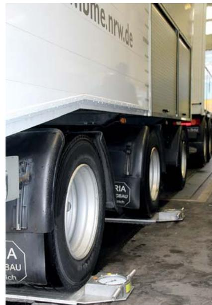
Statische Wägung auf einer Brückenwaage und Radlastwaagen
