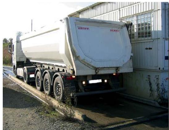
Wägung auf einer Brückenwaage
