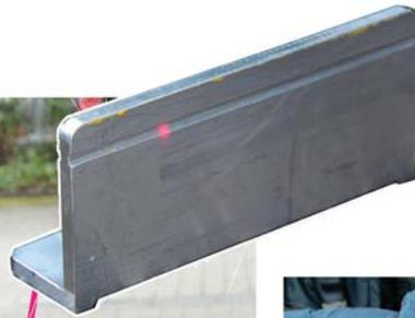
links: Mess- oder auch Zielwinkel mit Höhenmarkierung (entspricht der Austrittshöhe des Laserstrahls an der Neigungswasserwaage)
