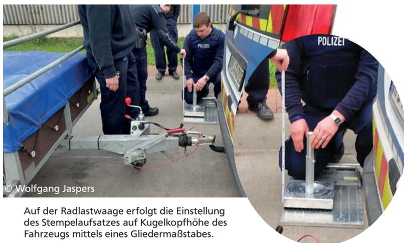
Auf der Radlastwaage erfolgt die Einstellung des Stempelaufsatzes auf Kugelkopfhöhe des Fahrzeugs mittels eines Gliedermaßstabes.
