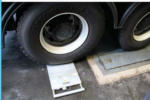
Foto links: Radlastwaage mit elektronischer Anzeige – Rad rechts steht auf der Fahrzeugwaage.
