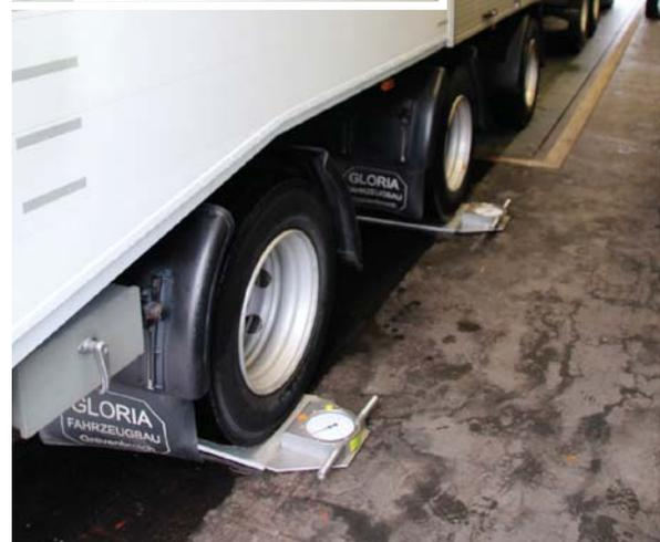
Die beiden letzten Achsen des Fahrzeuges stehen auf Radlastwaagen mit analoger Anzeige.
