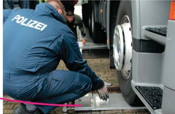
oben: Ausrichten der für den Einsatz verwendeten Radlastwaagen
