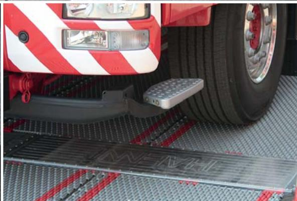
oben: Radlastwaagen-System mit Funkübertragung – gleichzeitige Messung bei Belastung aller Räder (EVOCAR) © Marco Mylius
