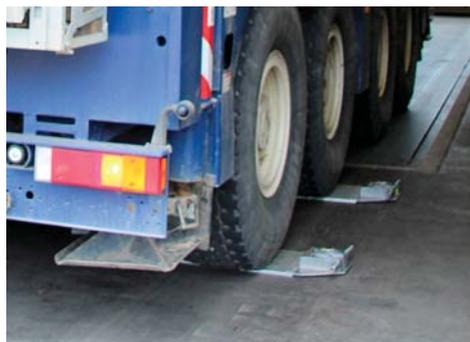
Foto rechts: Radlastwaage mit analoger Anzeige – je ein Rad steht auf den Radlastwaagen, die anderen Räder stehen auf der Fahrzeugwaage.
