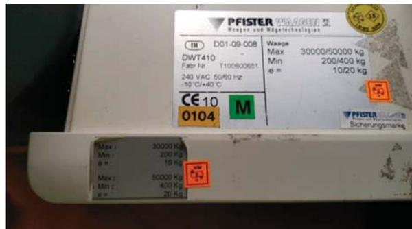
Diese Brückenwaage ist eine Mehrbereichswaage der Klasse III.
