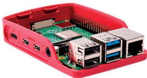
Bild 4: Der Einplatinencomputer Raspberry Pi
