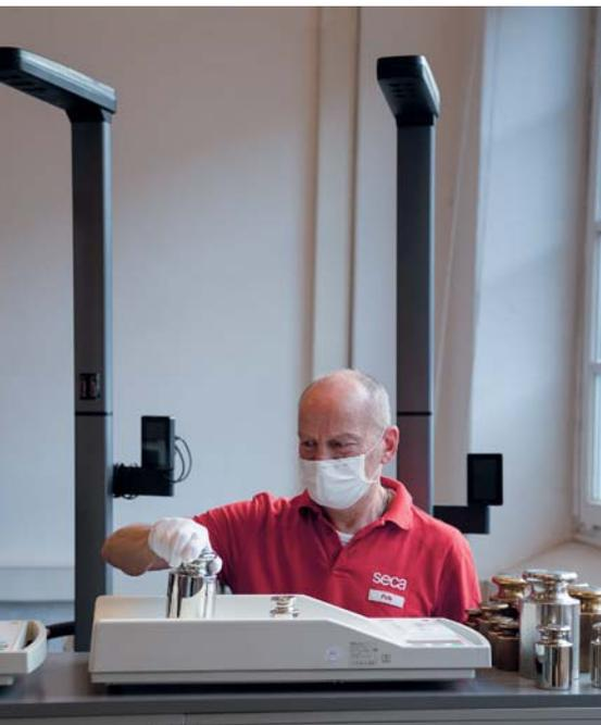
Vorbereitung der Babywaage zur Eichung – im Hintergrund: Ultraschall-Längenmessgeräte
