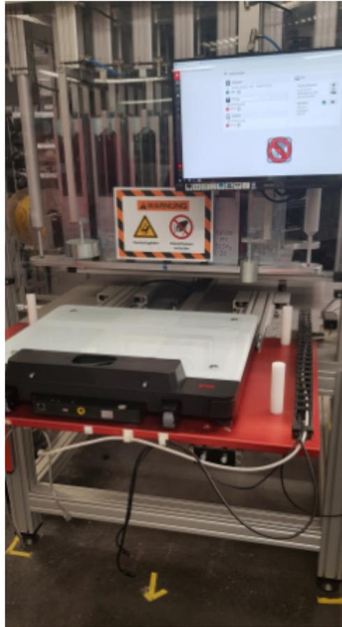
Abgleichautomat zur Justierung der Waagen. Die verschiedenen Normalgewichtsstücke werden von oben auf die Waage gesetzt.
