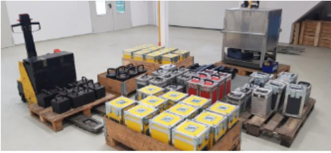
Gewichtehalle: Gebrauchsnormale (Gewichtsstücke) unterschiedlicher Genauigkeitsklassen – M1 (schwarze Gewichte 20/25 kg), F2 (gelbe/schwarze Kästen 50/20 kg), F1 (rote Kästen 20 kg) zur Prüfung von Waagen. Von „M1“ bis „F1“ steigert sich die Genauigkeit. Im Hintergrund steht eine Behälterwaage für Flüssigkeiten, zum Beispiel Schmieröle, um sie gravimetrisch zu bestimmen.
