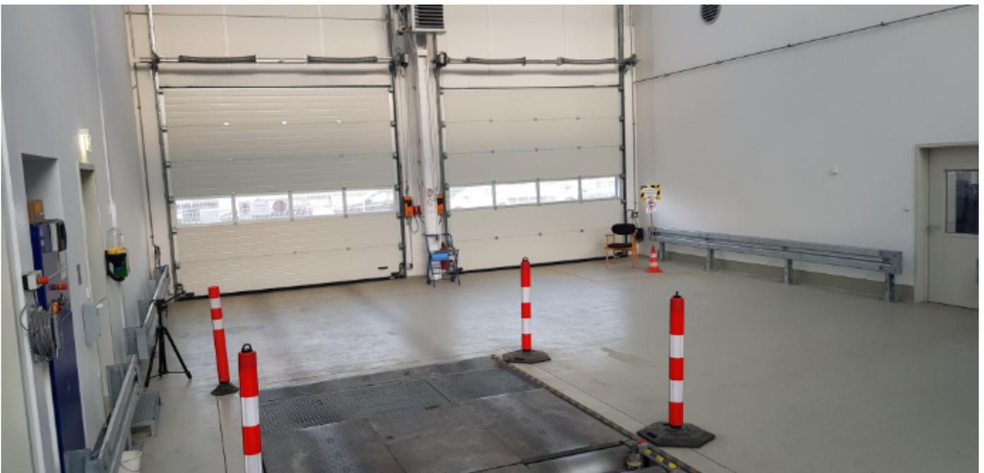
Steuerprüfhalle – im Vordergrund die Doppelrollen zur Aufnahme des zu prüfenden Taxis, auf der linken Seite ist im blauen Schrank die Steuerung für die Rollen unterbracht. Die Auswerteelektronik für die Prüfung der Fahrpreisanzeiger befindet sich im Raum mit den vorgelagerten Eingangsstufen. Der Prüfer setzt sich ins Taxi und startet die Prüfung mittels Fernbedienung.
