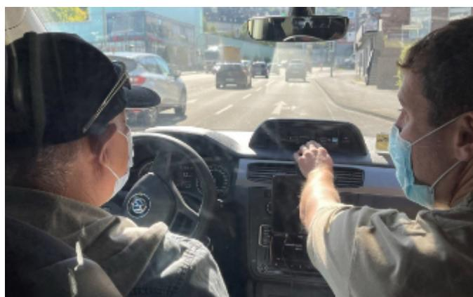
Der prüftechnische Teil zur Eichung des Fahrpreisanzeigers führt über eichamtlich vermessene Wegstrecke – Start und in Fahrt
