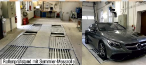
Rollenprüfstand mit Semmler-Messrolle
