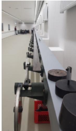
Längenprüfstand für 30 Meter Tankpeilbänder zur Messung der Füllhöhe in Lagerbehältern
