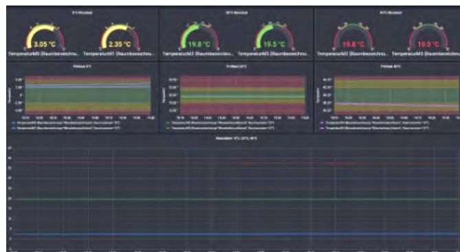
Monitoring der Badtemperaturen durch die Web-Anwendung Grafana
