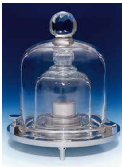
Er ist in Deutschland noch immer das „Maß aller Massen“: der nationale Kilogramm-Prototyp (Nr. 52) in der PTB, eine der Kopien des „Urkilogramms“.
