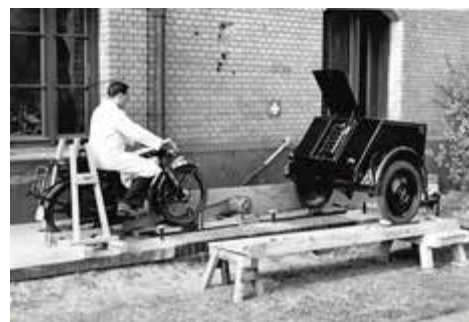
Prüfstand für Wegstreckenzähler an Motorrädern
