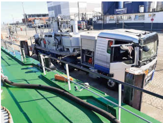
Blick vom Bunkerboot auf das Eichfahrzeug mit den aufgesetzten Eichkolben. Der Schlauch auf der Schlauchtrommel dient zur Rückführung des gemessenen Produktes.
