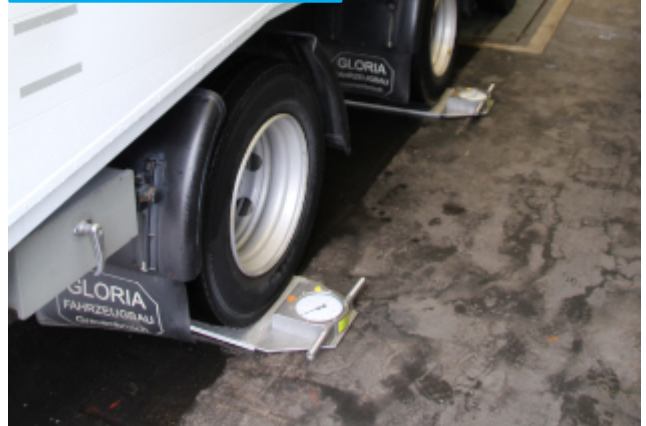
Die beiden letzten Achsen des Fahrzeuges stehen auf Radlastwaagen mit analoger Anzeige.
