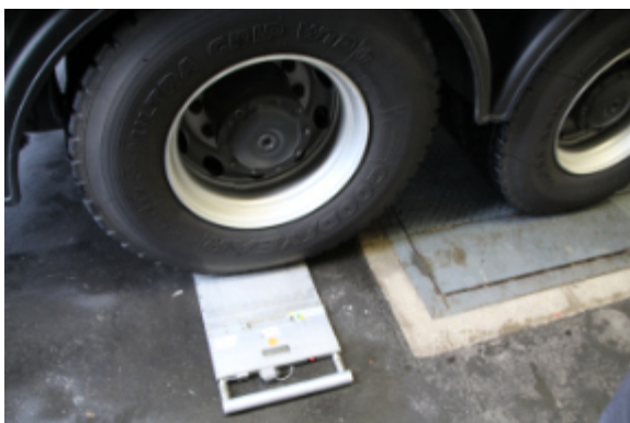
Radlastwaage mit elektronischer Anzeige – das Rad rechts steht auf der Fahrzeugwaage.
