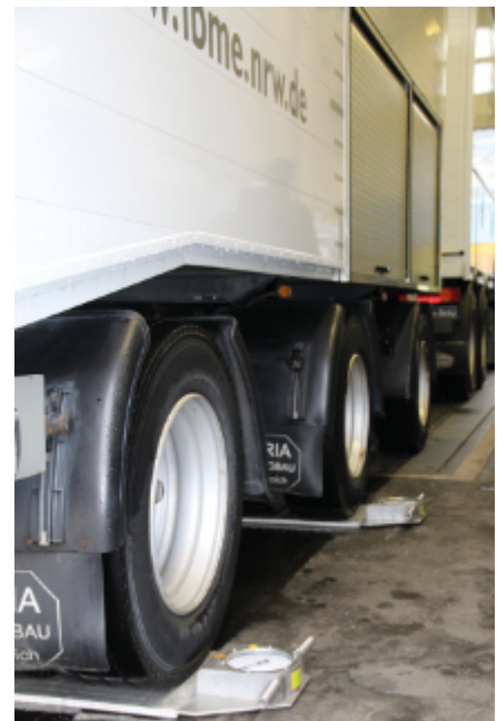
Statische Wägung auf einer Brückenwaage und Radlastwaagen
