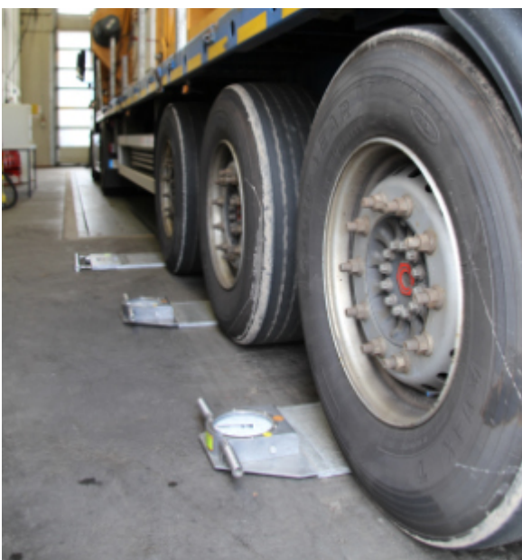
Die Radlastwaagen mit elektronischer und analoger Anzeige wurden vor die letzten drei Achsen des Sattelzuges positioniert.
