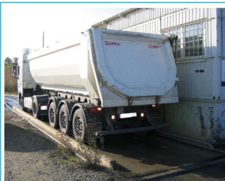
Foto: Brückenwaage mit Seitenführung
