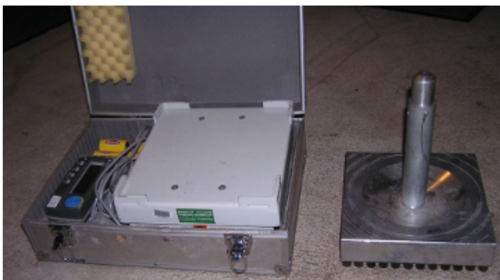
Waage mit Aufsatz zur Wägung der Stützlast von Einachsanhängern. Bei der Waage handelt es sich um eine 200-kg-Waage der Klasse III. Beim Aufsetzen der Anhängerkupplung ist besonders auf die Höchstlastüberschreitung zu achten, da sie zu Schäden an der Waage führen kann.
