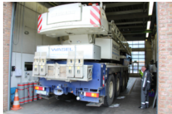
Radlastwaage mit analoger Anzeige – je ein Rad steht auf den Radlastwaagen, die anderen Räder stehen auf der Fahrzeugwaage. Auf der linken Lkw-Seiten ebenso!
