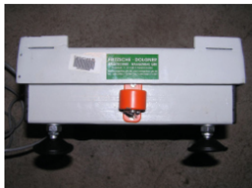
Nivellierfüße der Waage mit Libelle (rot) zur waagerechten Ausrichtung.
