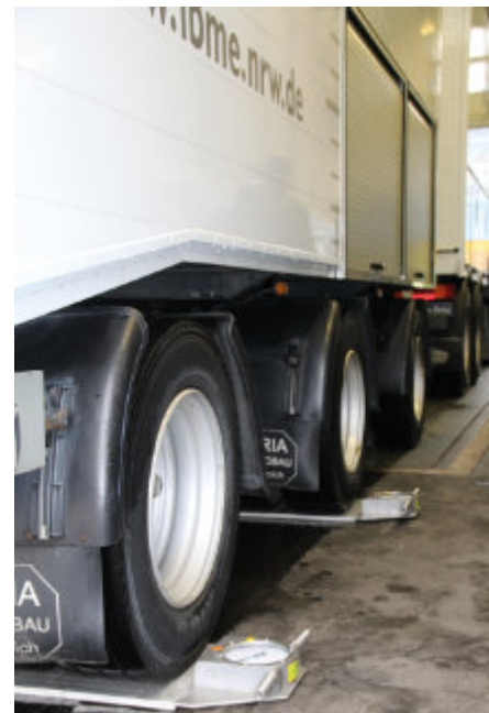
Statische Wägung auf einer Brückenwaage und Radlastwaagen
