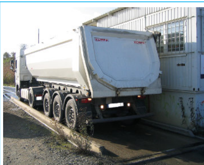
Foto: Brückenwaage mit Seitenführung
