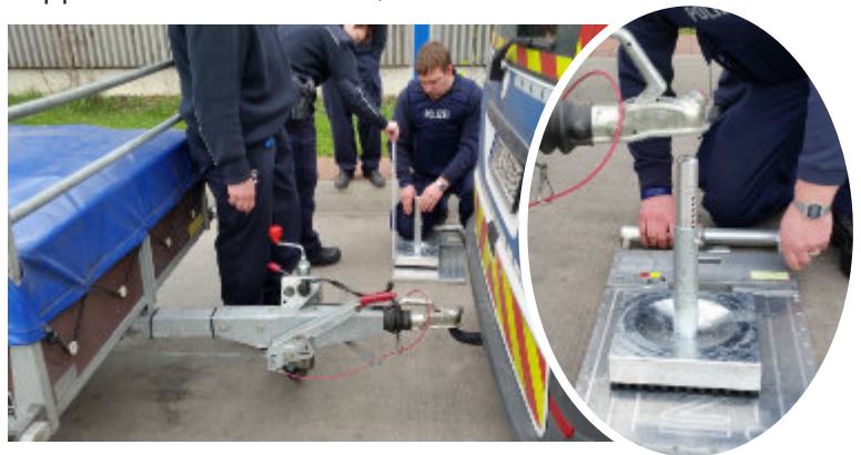
Auf der Radlastwaage erfolgt die Einstellung des Stempelaufsatzes auf Kugelkopfhöhe des Fahrzeugs mittels eines Gliedermaßstabes.
