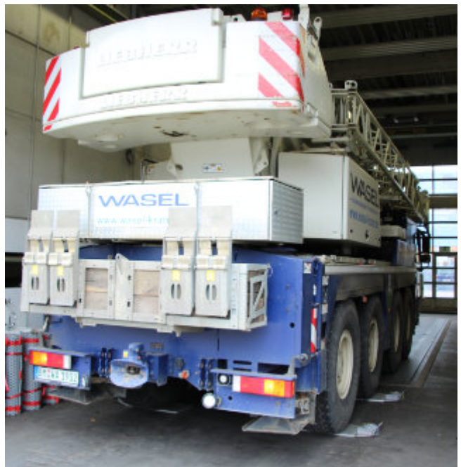
Die beiden letzten Achsen des Fahrzeuges stehen auf Radlastwaagen mit analoger Anzeige.
