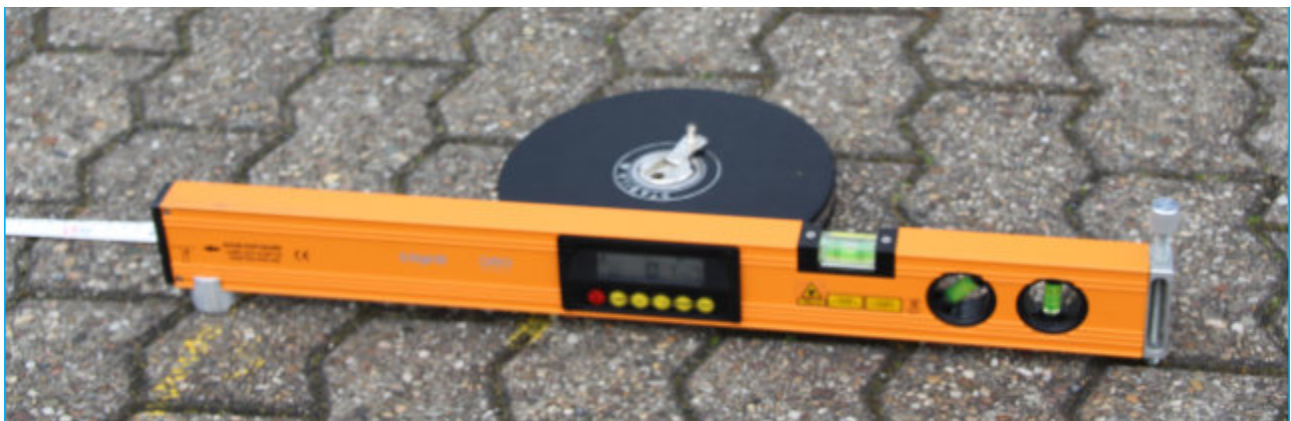
Anzeige der Laser-Neigungswasserwaage (Gefälle/Steigung in Prozent oder in Grad)
