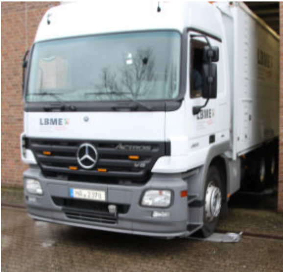
Foto oben/rechts/unten: Brückenwaage und elektronische Radlastwaage unter der 1. Hinterachse; rechts die Vorderachse auf der Radlastwaage und unten von vorn gesehen.
