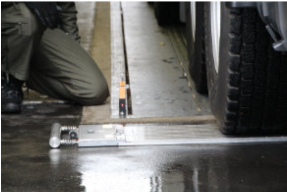
Foto oben/rechts/unten: Brückenwaage und elektronische Radlastwaage unter der 1. Hinterachse; rechts die Vorderachse auf der Radlastwaage und unten von vorn gesehen.
