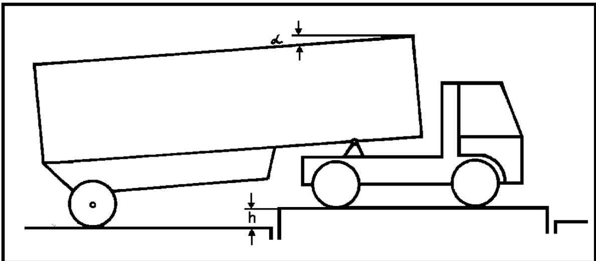
Abb. 4: Bei Sattelfahrzeugen mit einachsiger Sattelaullieger liegen dieselben Verhältnisse vor wie bei dem in Abb. 3 gezeigten Fahrzeug. Voraussetzung ist allerdings, dass der Auflagepunkt des Sattelaulliegers am Zugwagen keine Biegemomente aufnimmt. Davon kann in der Regel ausgegangen werden. Dasselbe gilt für die Radachse des Aufliegers.
