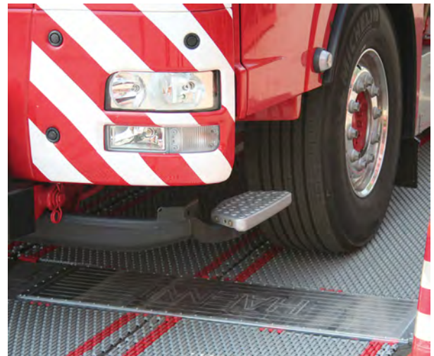
oben: Radlastwaagen-System mit Funkübertragung – gleichzeitige Messung bei Belastung aller Räder (EVOCAR)
