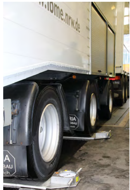
Statische Wägung auf einer Brückenwaage und Radlastwaagen
