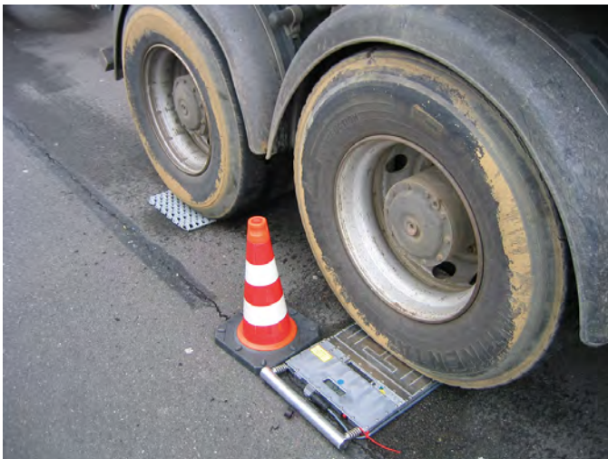
oben: Radlastwaagen-System mit Funkübertragung – gleichzeitige Messung bei Belastung aller Räder (EVOCAR)
