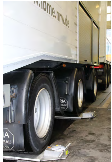
Statische Wägung auf einer Brückenwaage und Radlastwaagen
