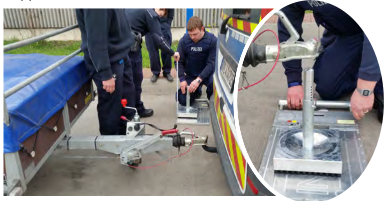
Auf der Radlastwaage erfolgt die Einstellung des Stempelauflages auf Kugelkopfhöhe des Fahrzeugs mittels eines Gliedermaßstabes.
