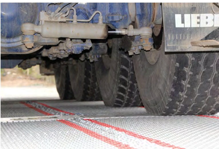
Ein Lkw bei der sehr langsamen Überfahrt, über die in den eingebetteten Radlastwaagen, zur Messung der Achslasten.
