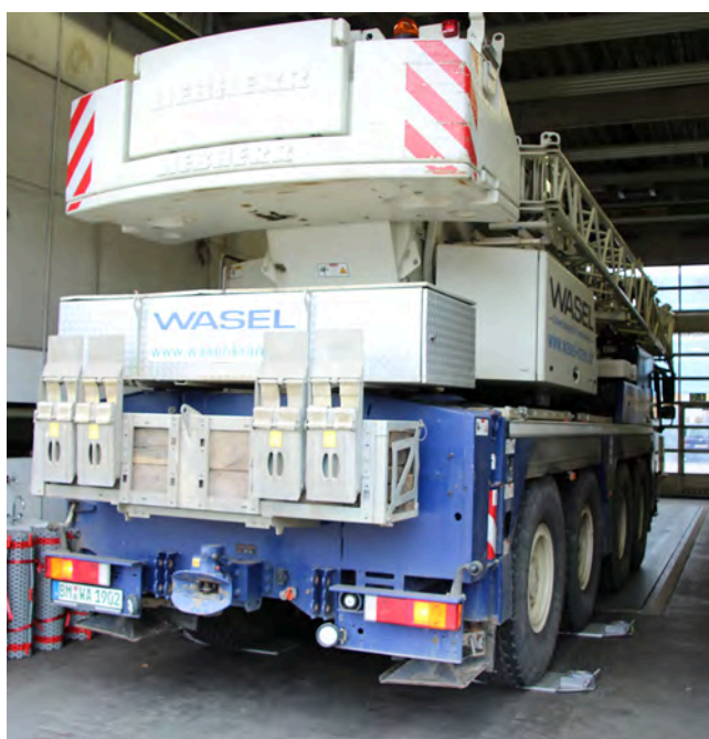
Die beiden letzten Achsen des Fahrzeuges stehen auf Radlastwaagen mit analoger Anzeige.
