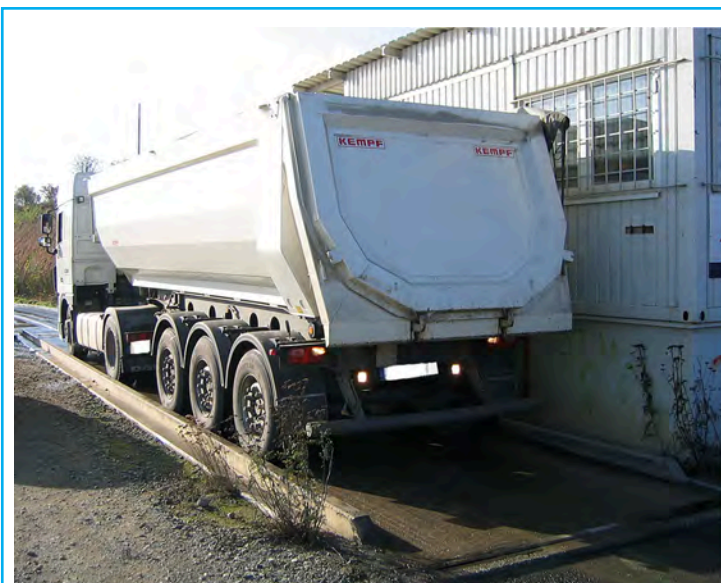
Foto: Brückenwaage mit Seitenführung
