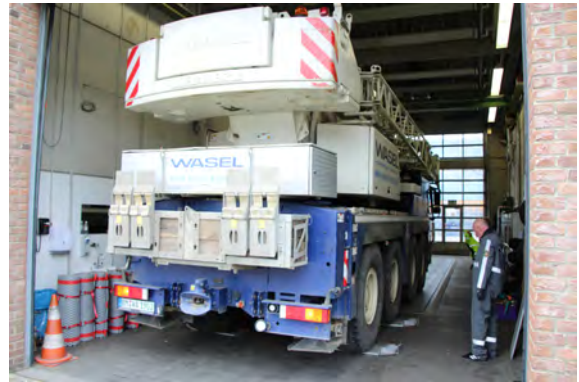
Radlastwaage mit analoger Anzeige – je ein Rad steht auf den Radlastwaagen, die anderen Räder stehen auf der Fahrzeugwaage. Auf der linken Lkw-Seite ebenso!
