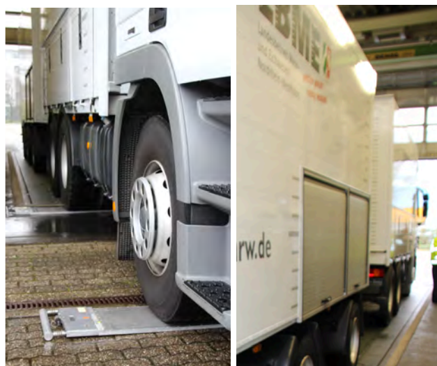
Foto oben/rechts/unten: Brückenwaage und elektronische Radlastwaage unter der 1. Hinterachse; rechts die Vorderachse auf der Radlastwaage und unten von vorn gesehen.
