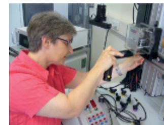
Befundprüfung von Versorgungsmessgeräten ist originärer Verbraucherschutz. Hier wird ein E-Zähler zur Befundprüfung vorbereitet. Hier schraube ich, Martina Steuer, natürlich bin ich BTE-Mitglied.
